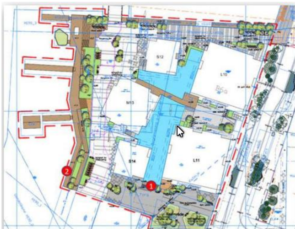
Figur 5. Bispevika, søndre basseng (B6b). I kartet vises to posisjoner (1 og 2) som Norsk Energi vurderer for inntak av kjølevann (kart mottatt fra Norsk Energi).
