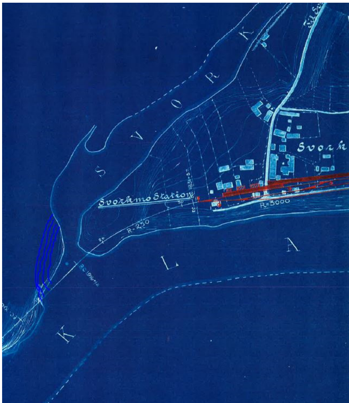
Figur 9. Kartskisse med Svorkmo jernbanestasjon som viser Svorkas opprinnelig utløp til Orkla, der NIVA har tegnet inn (blå linjer) dagens sprengte løp gjennom fast fjell. (Kartgrunnlag: ukjent)
