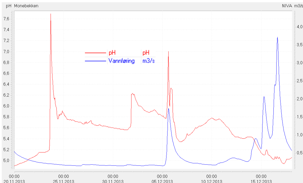
Figur 4. pH og beregnet vannføring i Monebekken senbøsten 2013. Figuren viser pH-reaksjonen på kalkingstiltak ved dumping av skjellsand og kalkpukk i bekken. pH økte momentant, men ble raskt redusert igjen til tilstanden før kalking.
