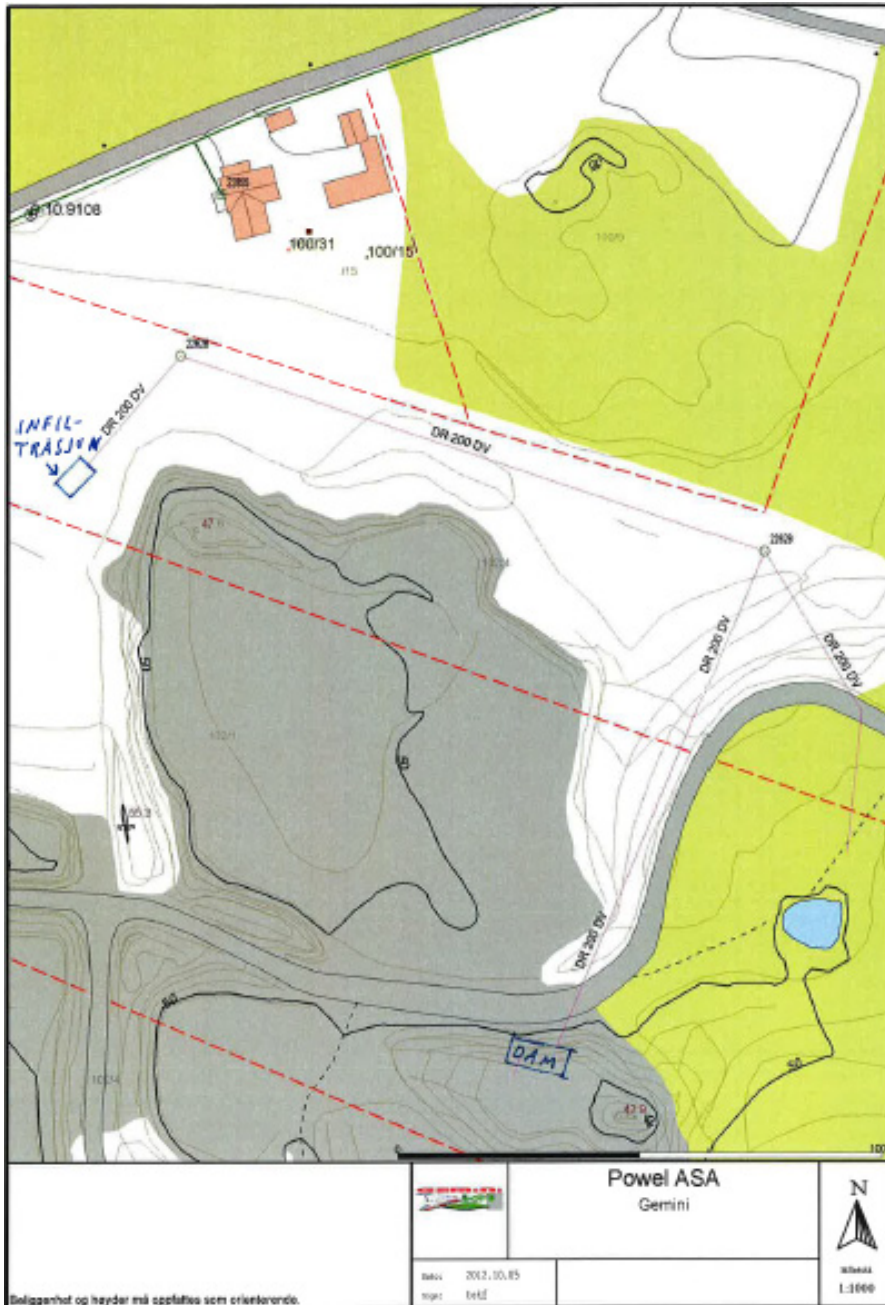
Figur 2. Kart som viser avskjærende groft mellom kum 22628 og 22629, tidligere infiltrasjonsområde, og nåværende dam for jernutfelling, som også er vist i Figur 4.
