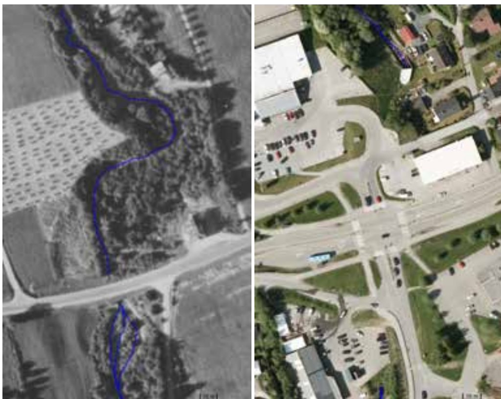
Figur 98. Flyfoto over problemkulvert under Fv 950/Gamle E6 fra 1947 (t.v.) og 2010 (t.h.). Lett forbivanding historisk; vandringsbarriere i dag. Flyfoto hentet fra http://kart.finn.no/ .
