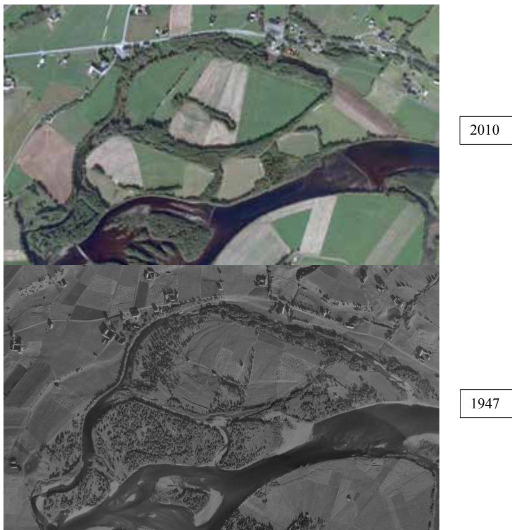
Figur 48. Flyfoto fra 2010 (øverst) og 1947 (nederst) som viser de store menneskeskapte endringene i det tidligere flomløpet., som i dag er redusert til Litjevja. (Flyfoto fra http://kart.finn.no/ )
