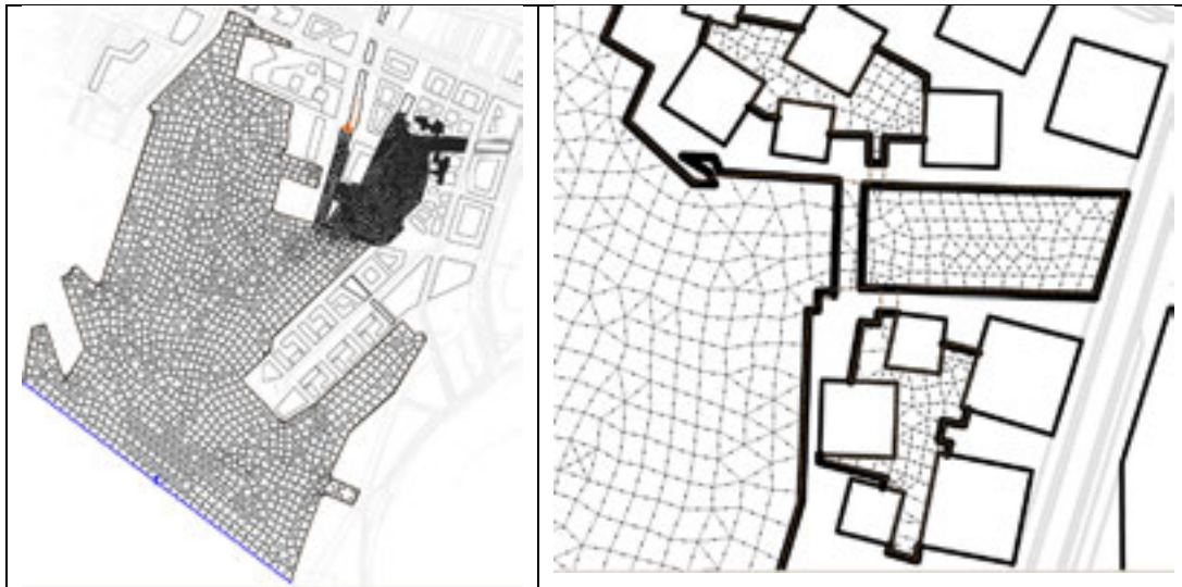
Figur 6. Nettverket eller gridet i RMA2-modellen for Bispevika er utgangspunktet for simulering av overflatesirkulasjonen. Venstre figur viser hele området. Høyre figur viser nettverket i bassengene. I hver node (avmerket som svart punkt) beregnes vannhøyden over referansedypet, strømrretning og strømhastighet. I midtre og sørlige del av modellområdet er oppløsningen 20 m, i Bispevika 10 m og i bassengene 5 m.
