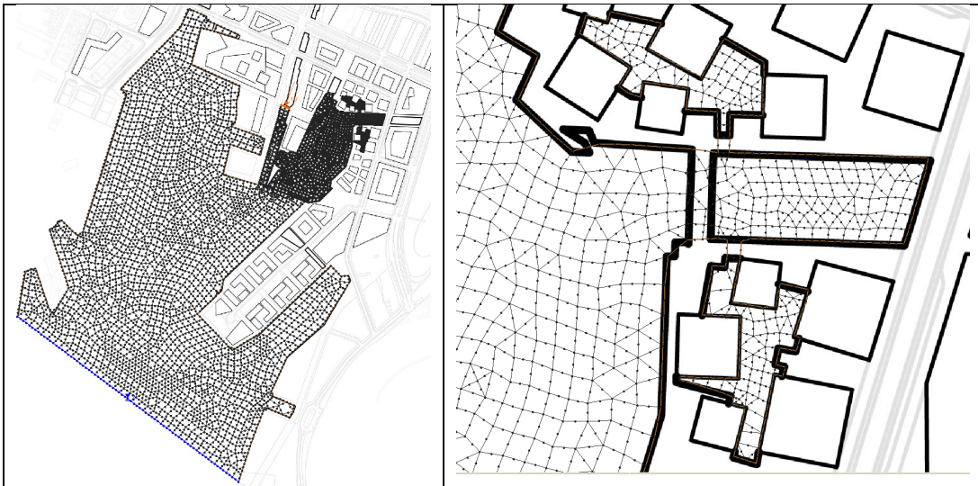
Figur 6. Nettverket eller gridet i RMA2-modellen for Bispevika er utgangspunktet for simulering av overflatesirkulasjonen. Venstre figur viser hele området. Høyre figur viser nettverket i bassengene. I hver node (avmerket som svart punkt) beregnes vannhøyden over referansedypet, strømretning og strømhastighet. I midtre og sørlige del av modellområdet er oppløsningen 20 m, i Bispevika 10 m og i bassengene 5 m.
