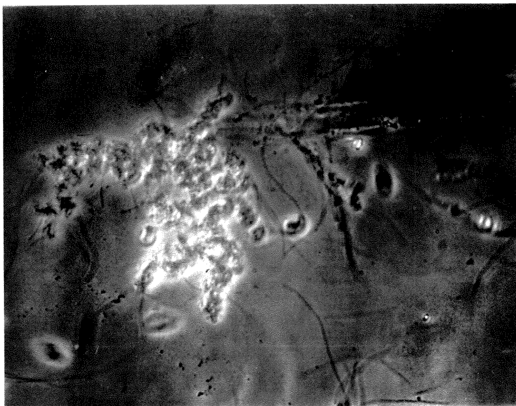
Mikroskoperingen av det aktive slam viste et høyt innhold av trådformige bakterier. Forstørrelse 500 x.
