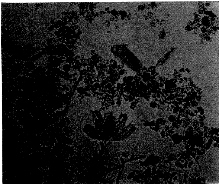
Aktivt slam fra renseanlegget (125x forstørret). Det var bra med fastsittende, høyere organismer i slamm.
