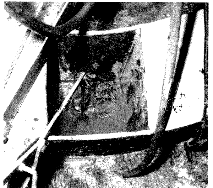
Utløpsrør med innstillbart overløp for konstant vannføring.
