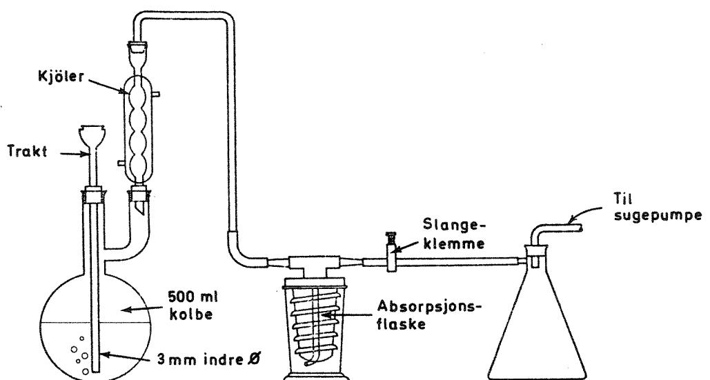
Fig.3 Glassutstyr for bestemmelse av oksyderbar cyanid etter forslag til ISO - standard
