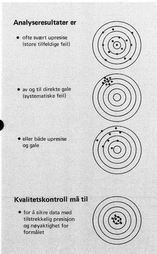
Figur 2. Virkning av tilfeldige og systematiske feil på analyseresultatene, illustrert ved prestasjonene til en som skyter på blink.
