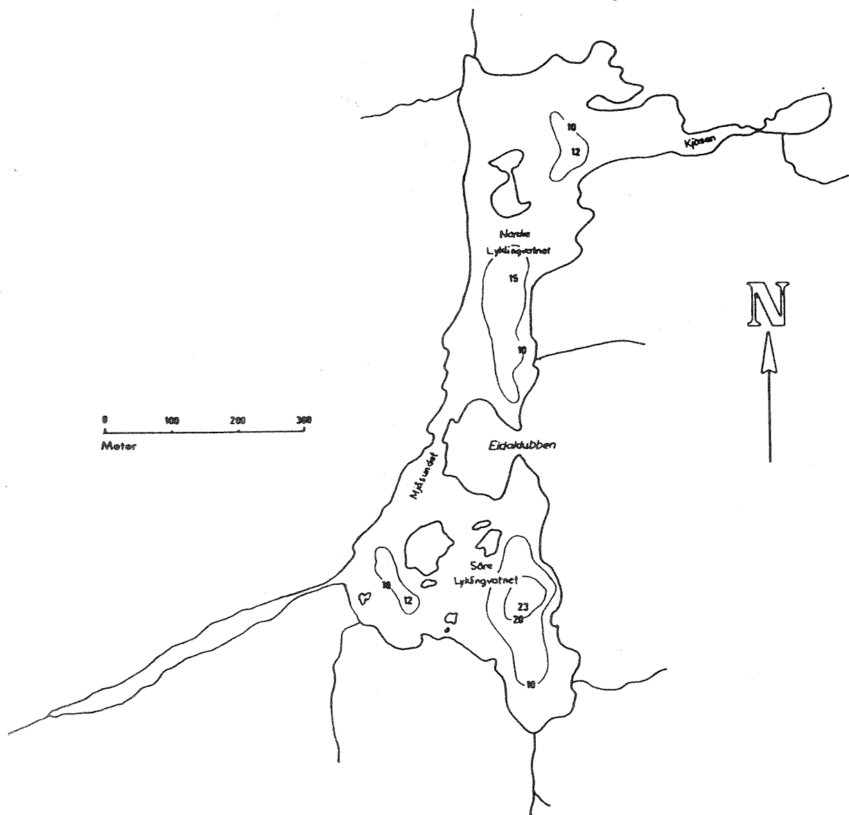
Figur 4.2.4. Dybdekart over Lyklingevatn. Kotene er tegnet på grunnlag av ekkogram og gir bare et grovt bilde av bunntopografien.
