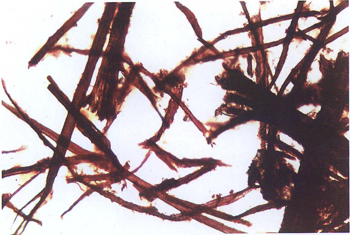
Fig. 8 Vika ved Helgelandsmoen (st. 41). Bildet viser mye tremasse både termomekanisk (Tmp) og slip (kortere fibre). 50 x forstørrelse.
