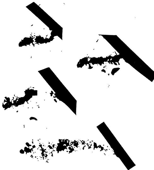
Røntgenblitsbilde som viser fragmentering og splinter av 12,7mm MP ved skyting gjennom 11mm panserplate. Mange av fragmentene vil stamme fra panserplata og ikke prosjektilet. (skyteretning fra høyre mot venstre). (kilde: Raufoss A/S).
