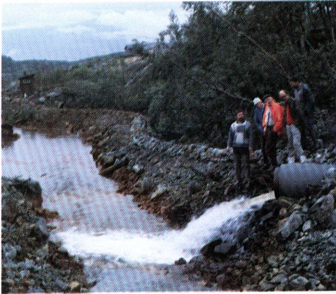
Samlet avrenning fra Skorovas Gruber for kalking. Sivevann fra gråbergvelt kommer inn fra høyre.
