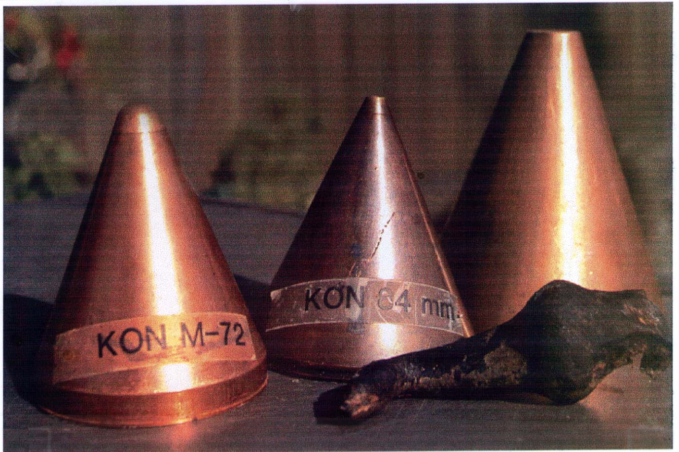
Figur 4. Det øverste bildet viser endel håndvåpen ammunisjon der prosjektilet består av en blykjerne omgitt av kobber. Nederst er det vist kobberkoner som er en bestandel i hullladningsgranater.
