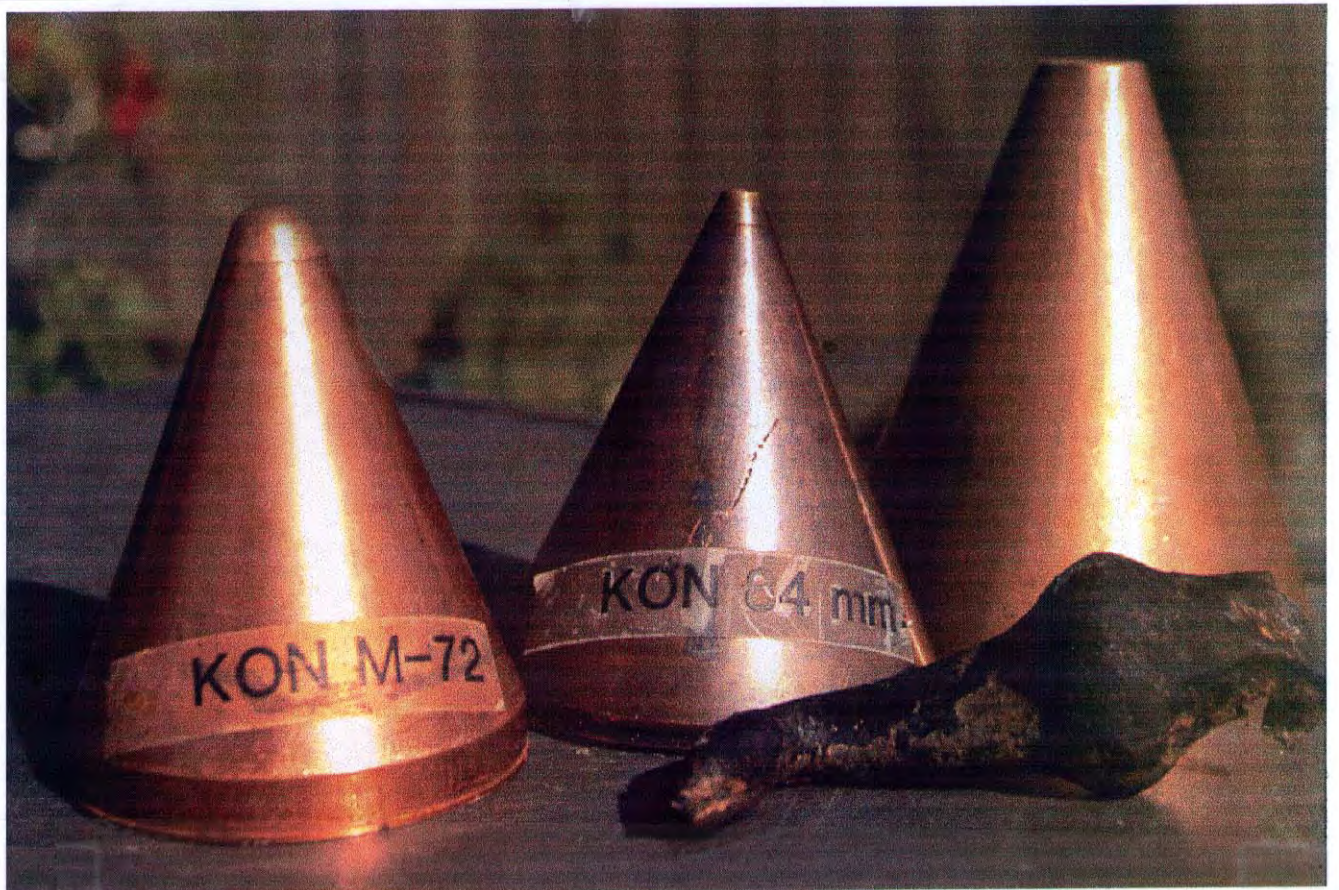
Figur 4. Det øverste bildet viser endel håndvåpen ammunisjon der prosjektilet består av en blykjerne omgitt av kobber. Nederst er det vist kobberkoner som er en bestandel i hulladningsgranater.
