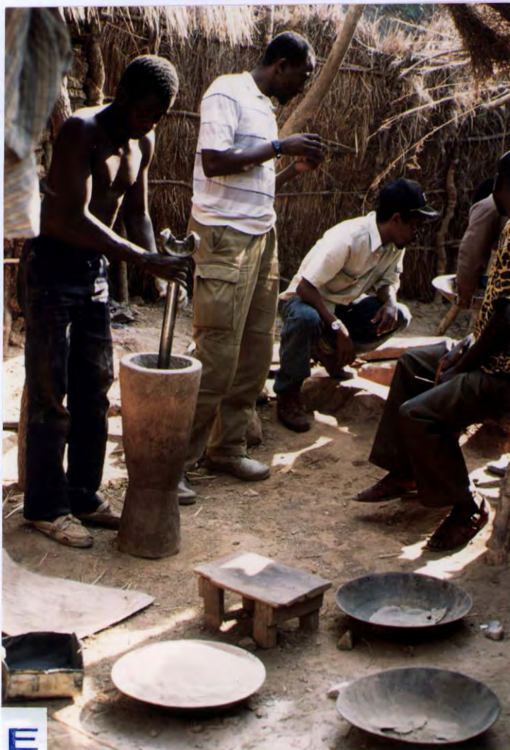
Figur 15. Fortsettelse. Resten (D.) knuses (E.), siktes (F.) og knuses igjen ned til et fint støv av gullholdig kvarts, og amalgameringsprosessen kan begynne.
