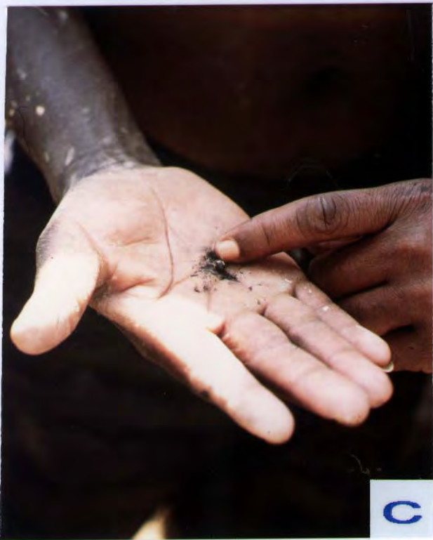
Figur 17. A. AuHg-amalgam presses sammen til en klump. B. Frigjøring av kvikksølv ved oppvarming. C. Amalgamert gull.
