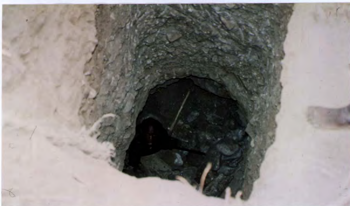
Figur 12 A. Lupa Gold Field. Small scale gold mining. Enkle gruvesjakter benyttet for å komme ned til gullbærende kvartsårer.
