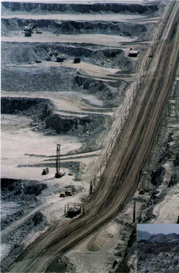
Figur 29. Fortsettelse Rössing Uranium Mine. B. Ulike aktiviteter: Boring og opplasting. Bilen nede på bildet er inne til kontroll for måling av urangehalt. Sjåføren får beskjed om lasten skal til prosessanlegg eller til gråbergstipp.
