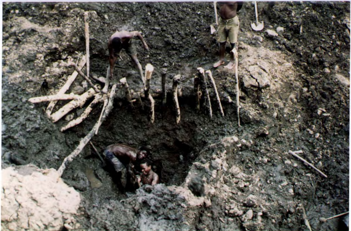
Figur 10. Small scale gold mining. Grupper av gruvearbeidere i arbeid med utvinning av gull fra gamle elvesedimenter ved Lupa Gold Mine.
