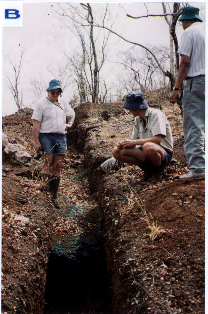
Figur 26. Copper Queen, Sanyati. A. Grøfter gravd under prospekteringsarbeide for å bestemme malmkroppens utbredelse og Cu-innhold. B. Detaljbilde, fra venstre: T. Roberts, A. duToit og R. Fernandes.
