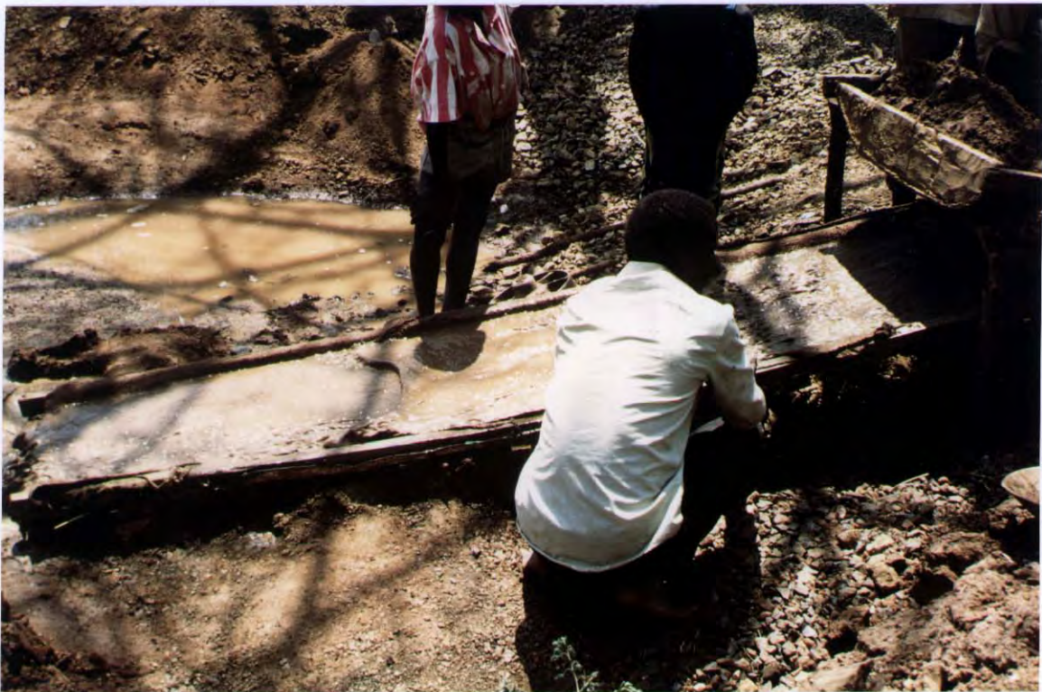
Figur 18. Sluic box, en inretning ("vaskebrett") for å vaske gull ut av større mengder gullholdig finmateriale.
