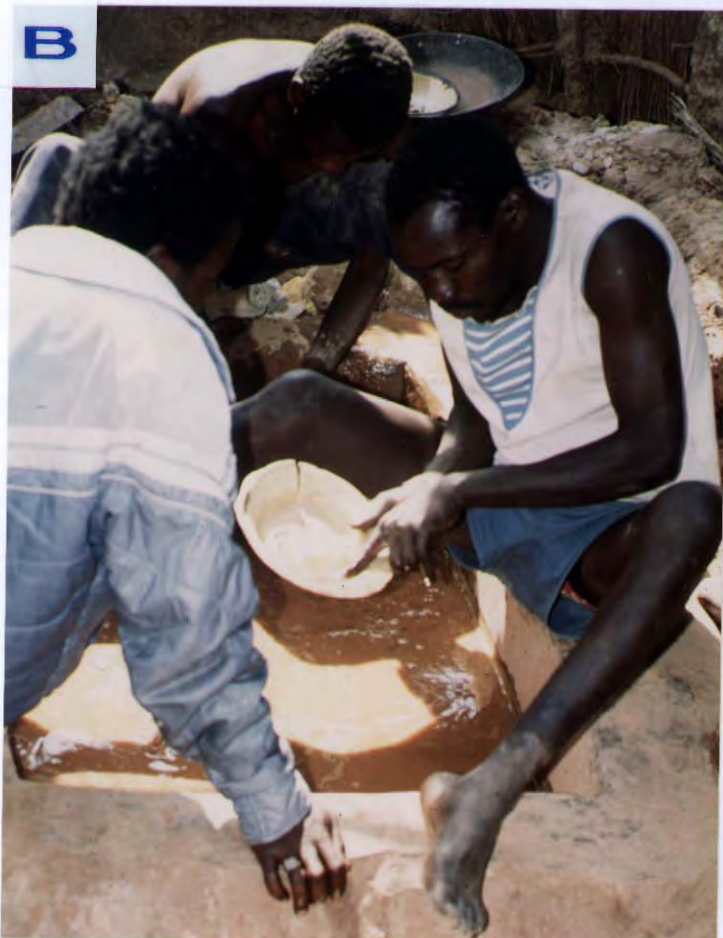
Figur 15. Lupa Gold Field. A. Den mekaniske prosessen tar til med grovknusing og sortering. B. Større biter (C.) frigjøres/vaskes fra vha. vanlig vasketeknikk.
