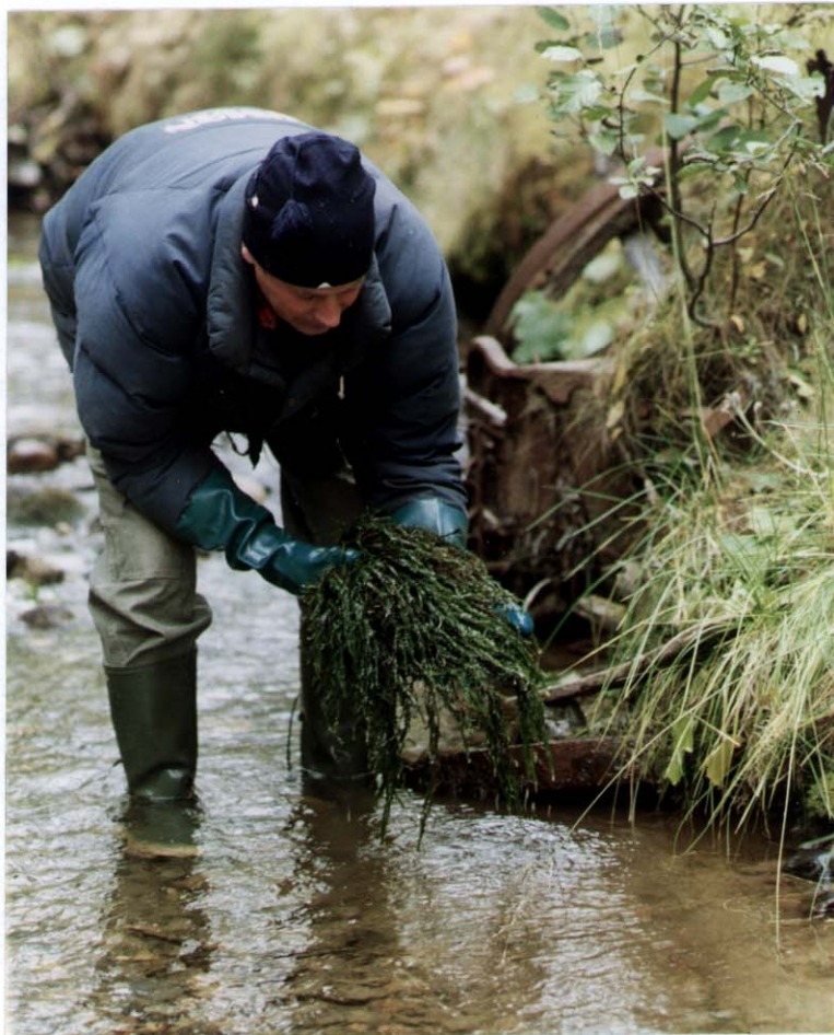
Vannmose blir brukt til akkumuleringsforsøk for tungmetaller
