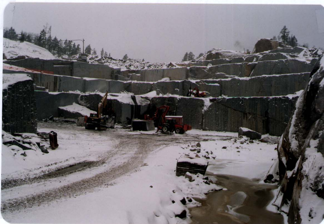
Fig.4 Avrenningen fra selve bruddområdet er gjerne svært turbid, se pumpesump i forkant av bilde. Der denne avrenningen ledes direkte til vassdrag, er dette en vel så stor forurensning som avrenning fra skrotsteindeponier.
