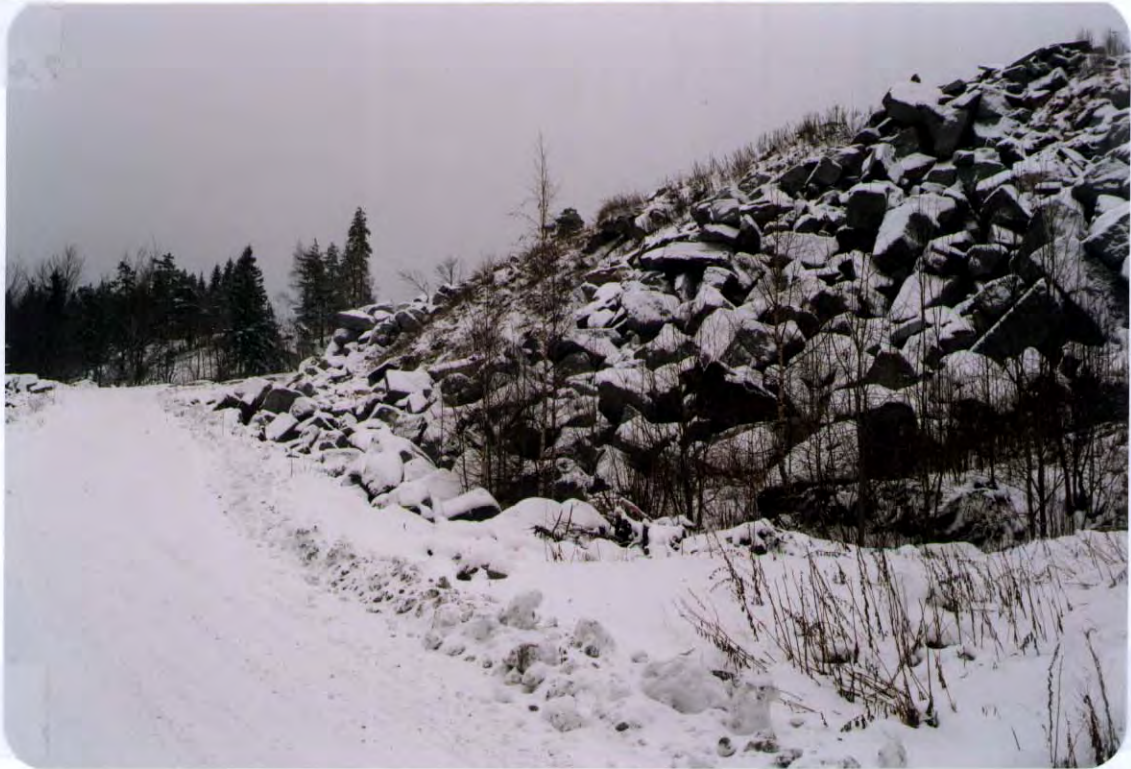
Fig.1 Dagens skrotsteintipp ved vestre Malerødbruddet. Denne type fylling vil fortsette nedenfor veien til venstre i bildet ned mot Nordre Malerødtjern og til slutt fylle igjen dette, se neste bilde.
