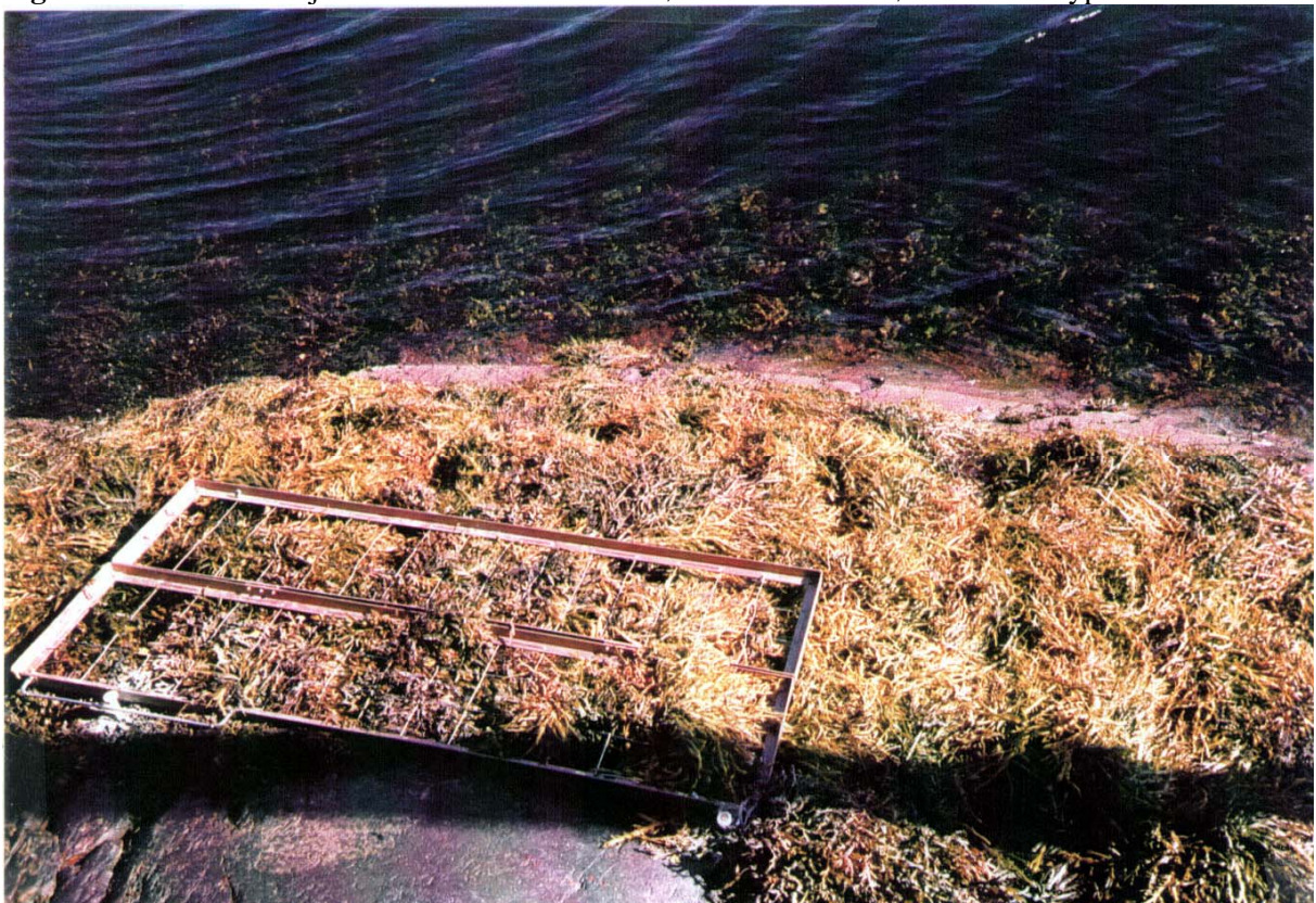
Figur 36. Plassering av rammen i fjæra. Rammens posisjon er bestemt av to nylonbolter som er slått ned i fjellet.
