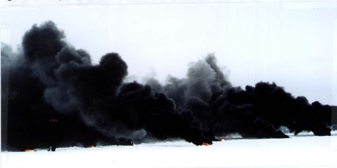
Figur 3. Utvikling av røyk fra den antracene baserte røkgeneratoren.
