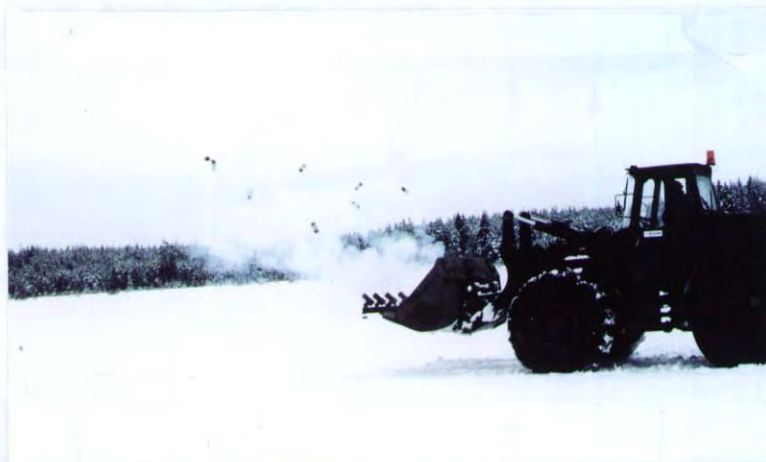
Figur 1. Utskytning av 8 røykbokser fra stativ montert på en hjullaster.
