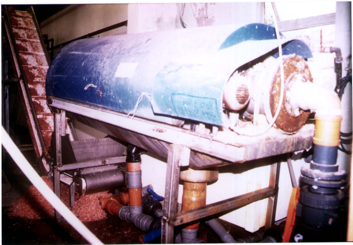
Figur 6. Transport av rekeskall fra trommelsil og direkte til reaktor for produksjon av kitosan ved Havmannen A/S
