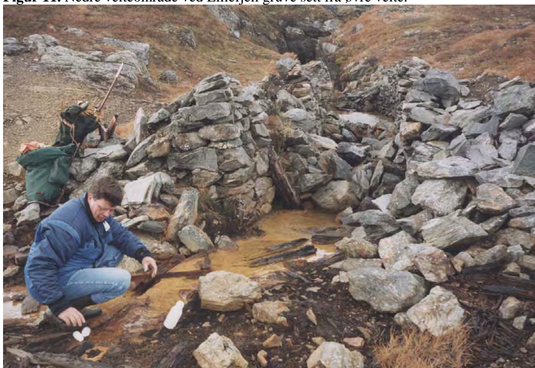
Figur 12. Prøvetaking ved utløpet av vannstollen ved Lillefjell gruve.
