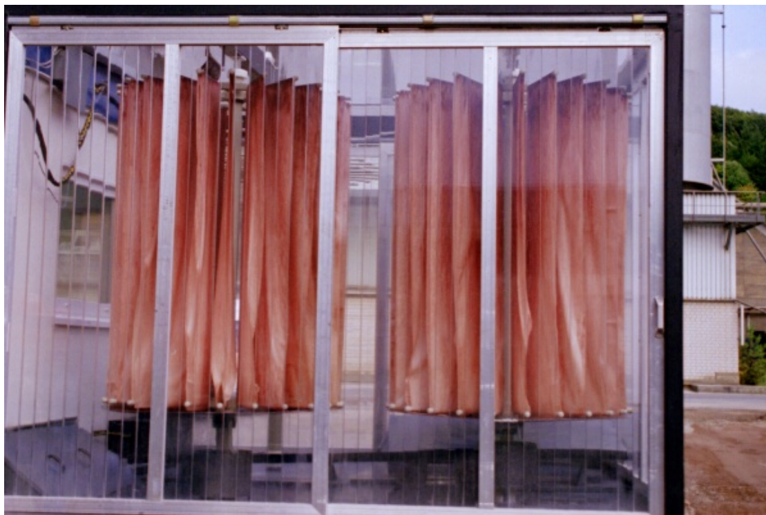
Figur 15. Produksjon av mikroalger immobilisert på fiberduk (Tyskland).
