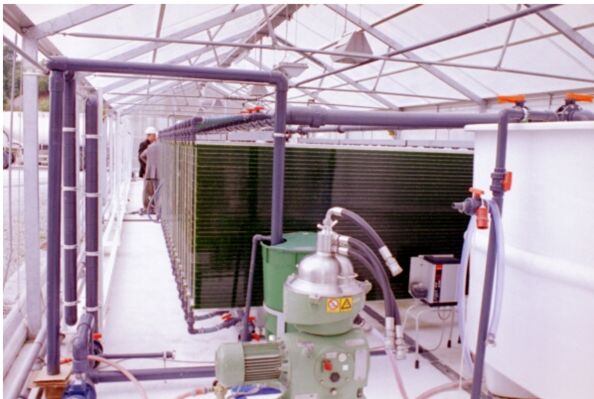
Figur 13. Algereaktor for konvertering av CO 2 . Sementfabrikk, Elbingerode, Tyskland (Preussag AG).
