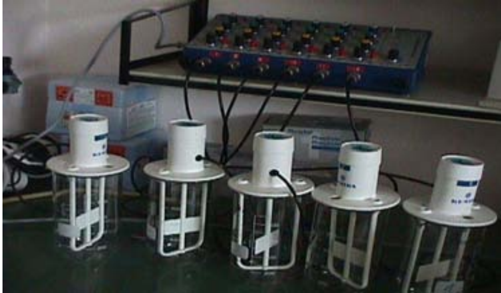
Figur 1. Jar-test apparat med omrørere og begerglass som ble benyttet i laboratorieforsøkene
