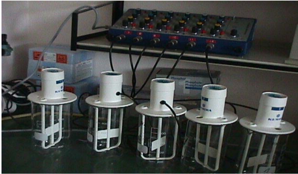
Figur 1. Jar-test apparat med omrørere og begerglass
