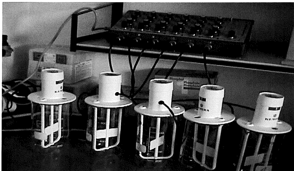
Figur 2. Jar-test apparat med omrørere og begerglass
