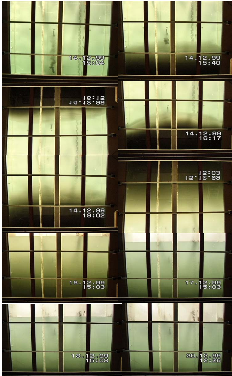
Figur 2. Storskalaforsøk (F2) med utpumping av sediment i anoksisk sjøvann. 2 l ble tilsatt støtvis 14.12. kl.15:04-16:14. Deretter ble 8 l tilsatt kontinuerlig i løpet av et minutt. Lekkasje ved øvre tverrbjelke ga synkende vannstand mot slutten av forsøket. Karet er belyst ovenfra. Linjalen på karetets bakvegg viser hvordan sikten varierer.
