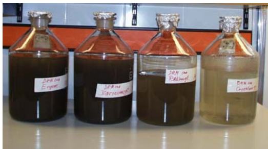
Figur 5. Sedimentering av partikler i smeltede snøprøver under forhold uten turbulens. 1. Umiddelbart etter oppristing av prøvene. 2. Etter én times sedimentering.
