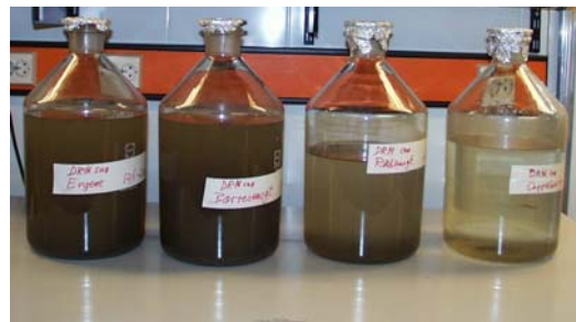
Figur 5. Sedimentering av partikler i smeltede snøprøver under forhold uten turbulens. 1. Umiddelbart etter oppristing av prøvene. 2. Etter én times sedimentering.
