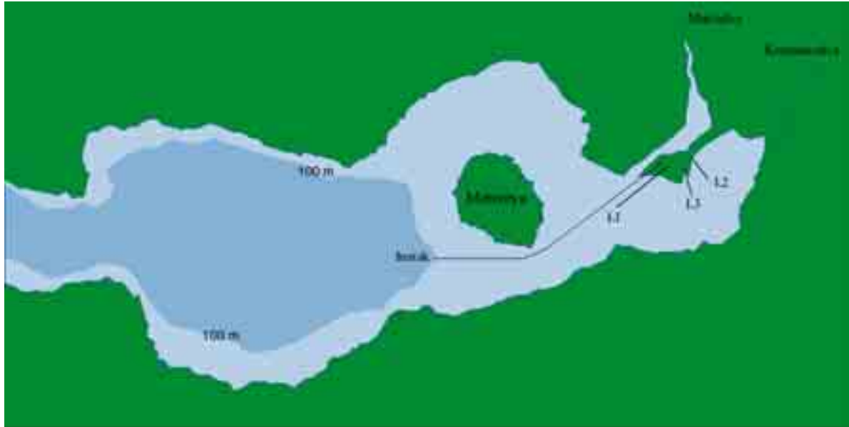
Figur 1. Indre del av Masfjorden, ved Matre. Kartet syner også omtrentleg plassering av eksisterande utslepp (L1 og L2), planlagt nytt utslepp (L3) samt planlagt inntaksleidning.
