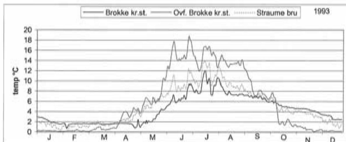
Figur 7. Eksempel på forskjell i vanntemperatur på terskelbassengstrekningen oppstrøms Brokke og strekningen Brokke – Straume bru. Døgnmiddeltemperatur på stasjonene 21.75 Otra oppstrøms utløp Brokke kraftverk, 21.74 Brokke kr.st. og 21.76 Straume bru i 1993. (Data fra NVE).
