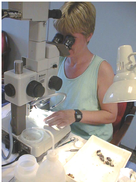
Venstre: registrering av imposex gjøres vha. stereomikroskop. Ovenfor: hunnensnegle med VDSI=4; sædlederen går hele veien fra kjønnsåpning til penis. Foto: NIVA
