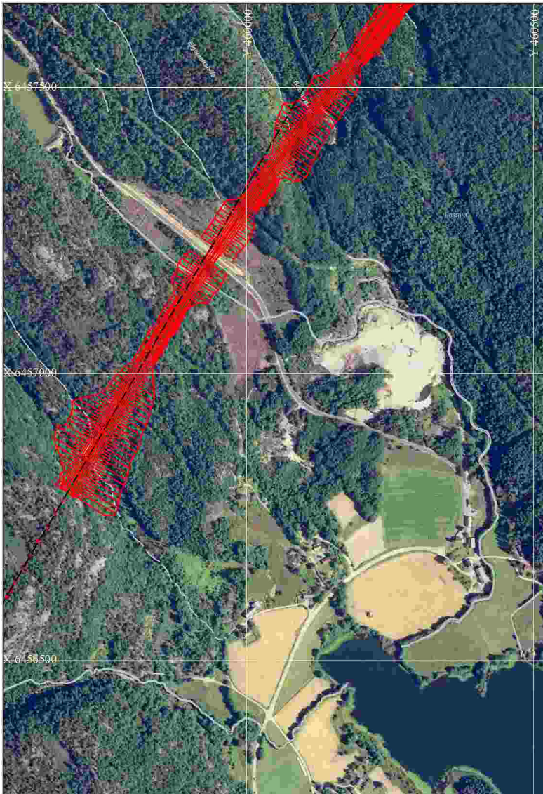
Figur 12. Planlagt kryssing av Glamslandsvassdraget på tre steder. Elva ligger sentralt i bildet, mens kryssingen av myr ligger såvidt utenfor venstre bildekant.
