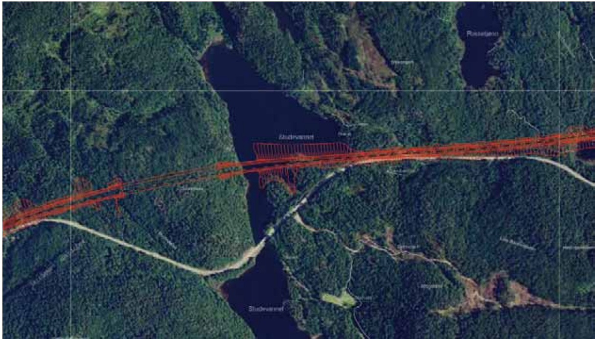
Figur 25. I søndre del av Studevatn kommer planlagt E 18 i fylling ut i vannet.
