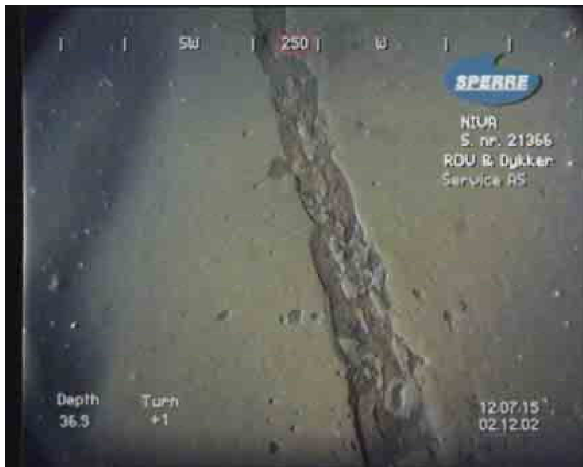
Figur 13. Merker av kjettingen på bunnen ved ankringsposisjon B.
