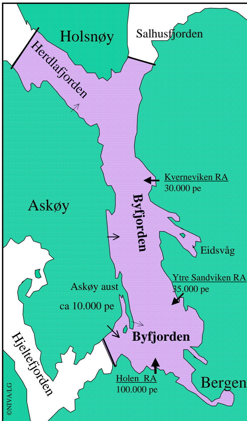
Figur 2. Kart over Byfjorden med avlaupspunkta frå Holen og Ytre Sandviken renseanlegg. Kartet syner også andre større utslepp/bidrag til sjøområdet. Grensene for Byfjorden er i h.h.t. definisjon av Lilletvedt (1994). Total sett mottar det skraverte området utslepp tilsvarande ca 175.000 pe, men deler av desse tilførsleane ligg utanfor det sentrale Byfjordbassenget.
