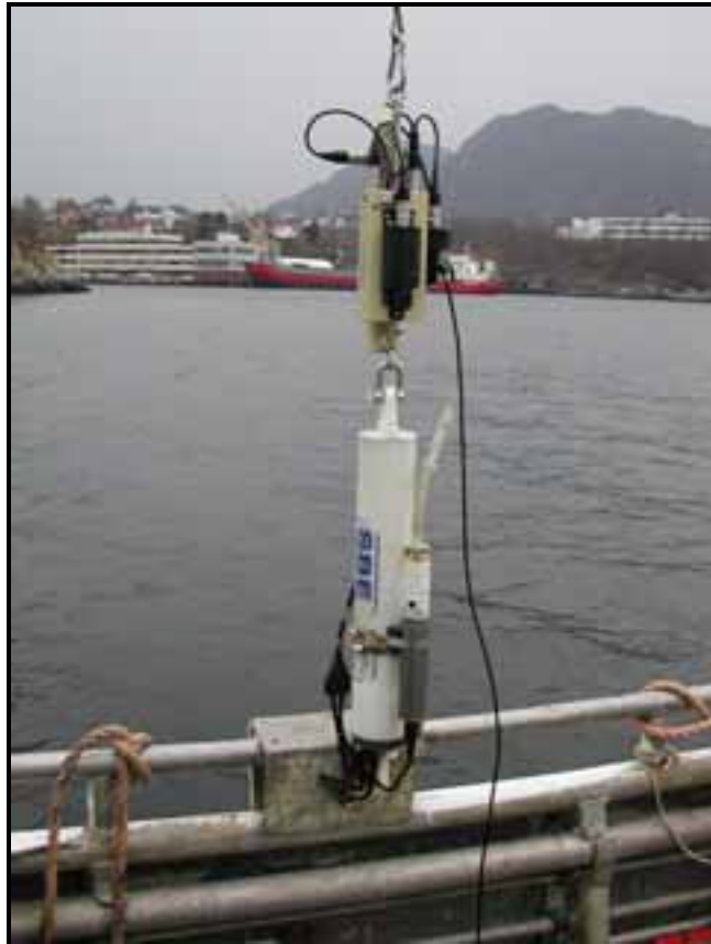
Figur 8. SAIV SD202 med sensorar, samt Seabird SBE-19 STD hengande under i samband med interkalibering.
