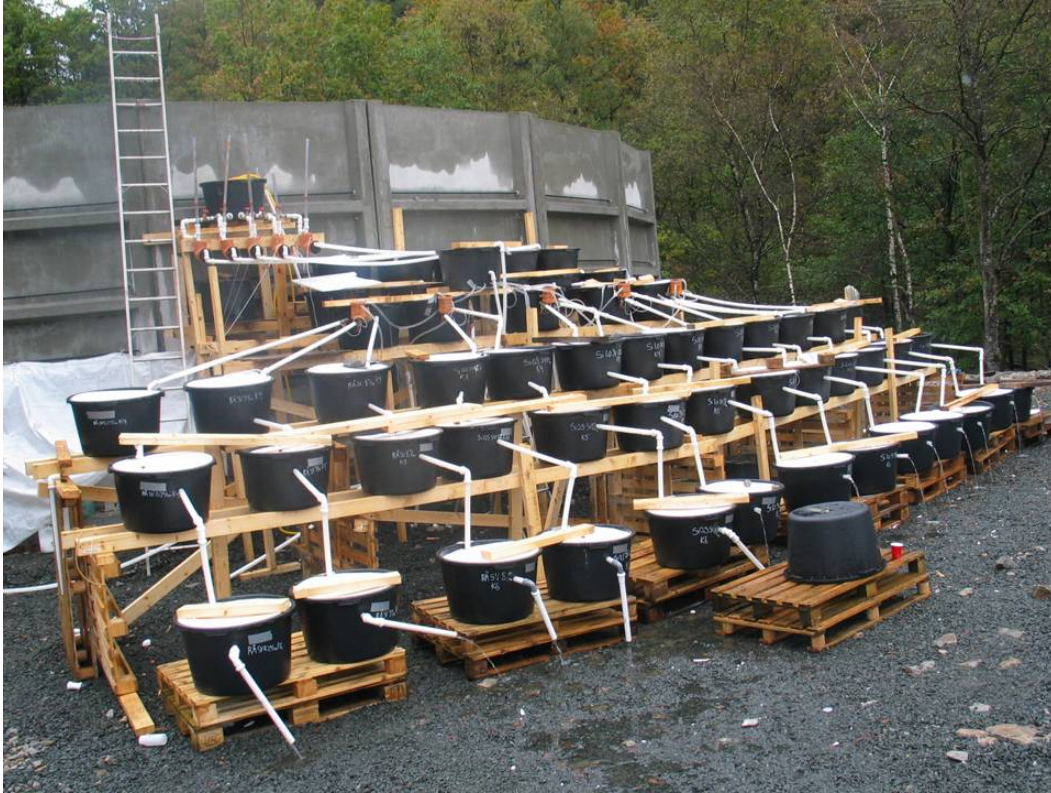
Figur 5. Foto som viser forsøksoppsettet. De tre øverste nivåene består av ferskvann med ulike oppholdstider etter vannbehandling, mens de tre nederste nivåene består av tre ulike oppholdstider etter sjøvannstilsetning (Foto: F. Kroglund).
