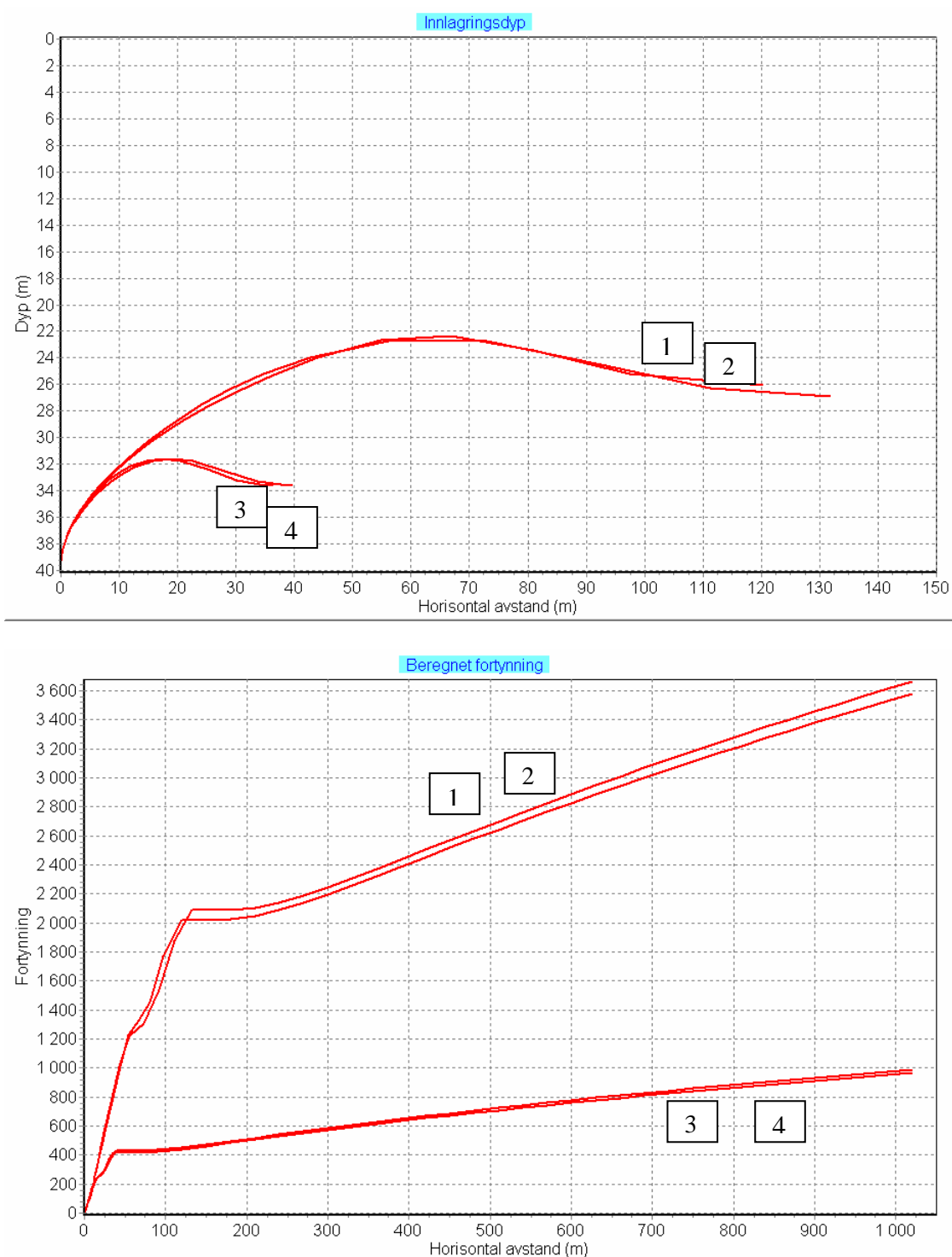
Figur 4. Beregnet innlagringsdyp og fortynning for avløpsvannet for de fire vertikallprofilene, vannmengde 39 l/s og ved strømhastighet 15 cm/s. Sentrum for skyen med fortynnet avløpsvann ligger dypere enn 25 m. Øverste kant av skyen er antydnet med stiplede linje og ligger omkring 20 m dyp. Se Tabell 2 mht. datoer for målingene.
