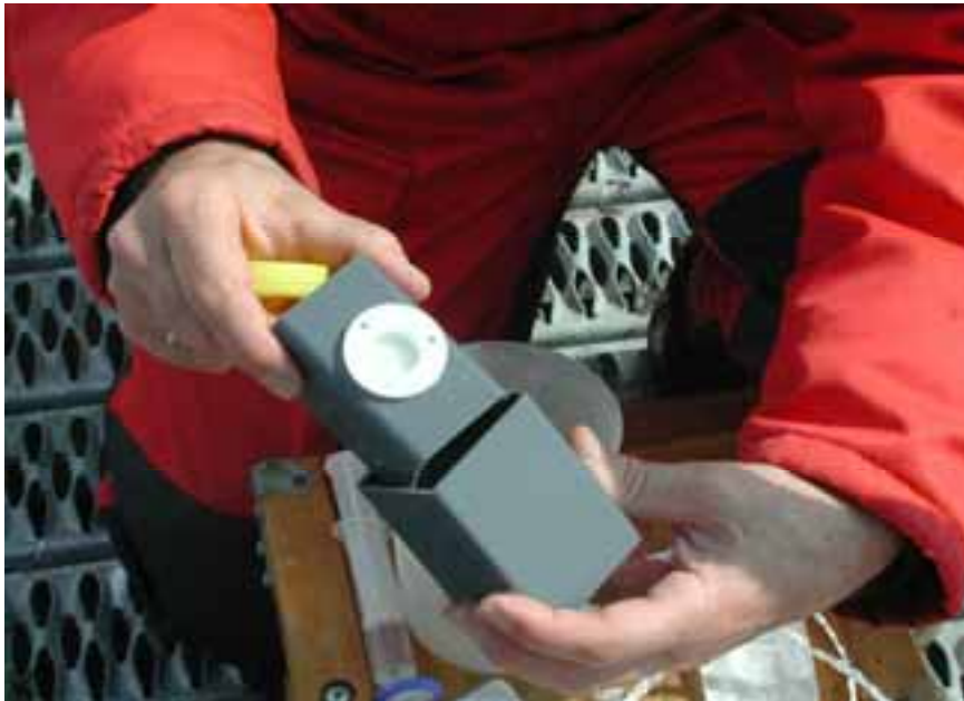
Figur 1. DGT (hvit) prøvetaker monteres i PVC-rør for eksponering ved et oppdrettsanlegg.
