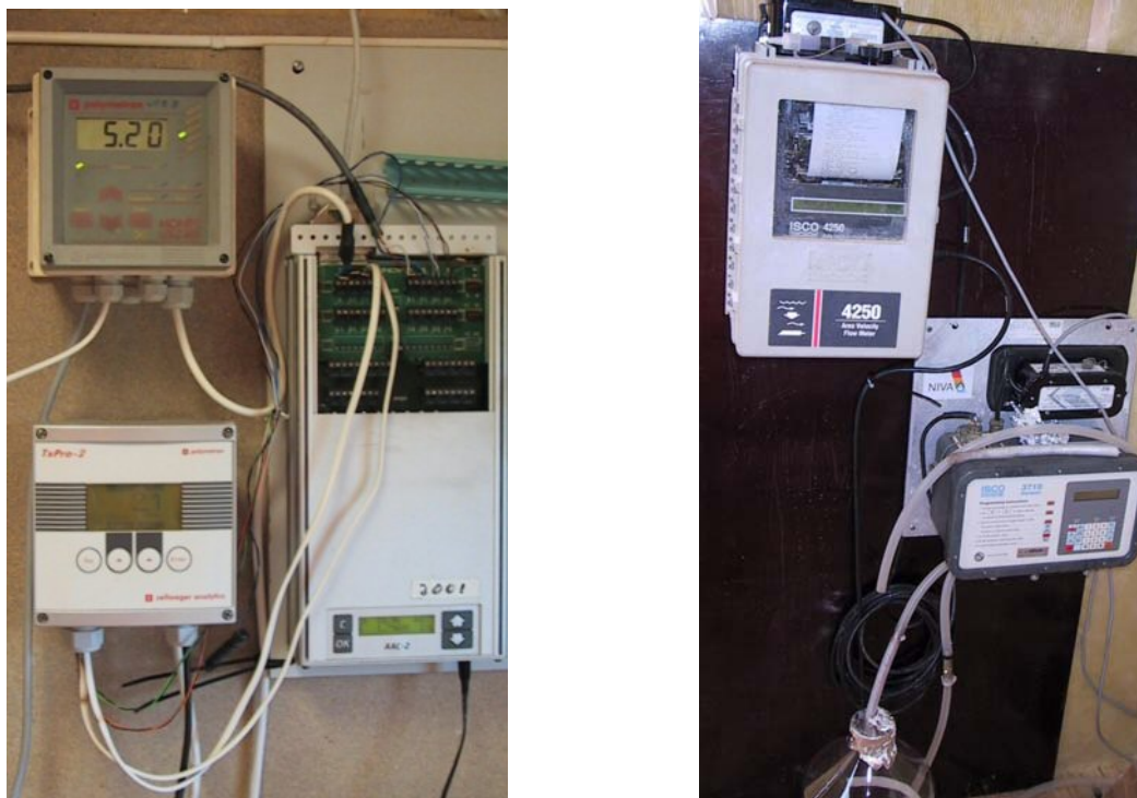
Figur 17. Måleinstrumenter i bu ved bassenget for kontinuerlig registrering av konduktivitet, turbiditet, temperatur og vannføring samt innhenting av vannføringsproporsjonale vannprøver.
