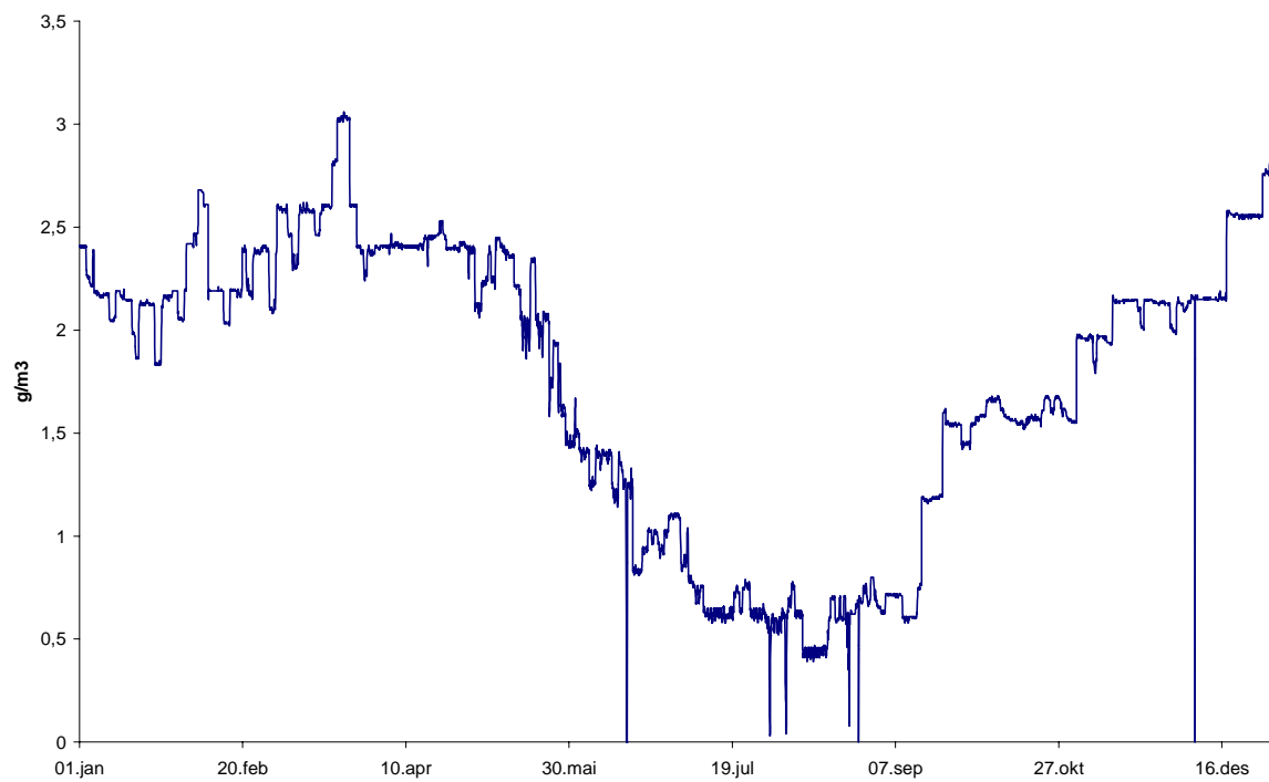
Figur 5. Styringssignal som dose på Håverstad doseringsanlegg i 2004. Figuren viser hvordan dosene stadig ble forandret etter behov. Det var gjennomgående lave doser om sommeren.
