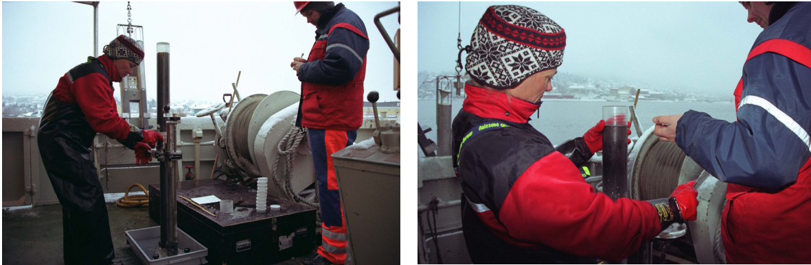
Figur 3. Situasjonsbilde fra prøvetaking av sedimentkjerner til ^{210}\text{Pb} datering i Drammensfjorden (©foto Alfred de Haas)
