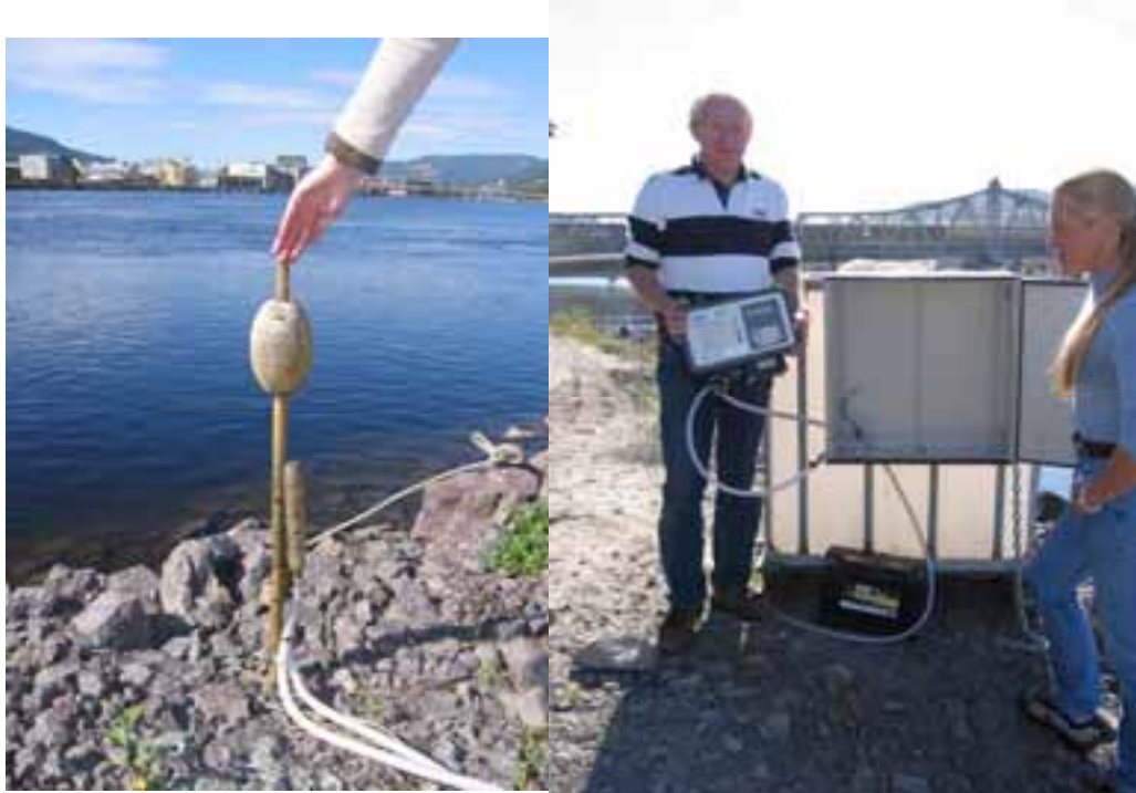
Figur 2. Oppsett for prøvetaking av store mengder vann for oppsamling av partikler i Drammenselva
