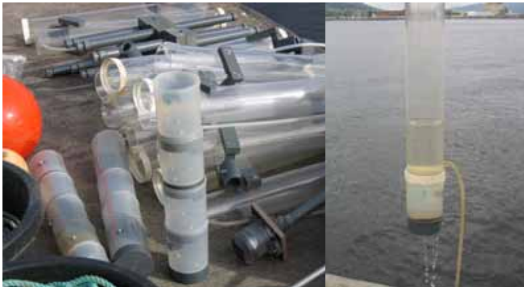
Figur 5. Sedimentfeller for utplassering i Drammensfjorden
