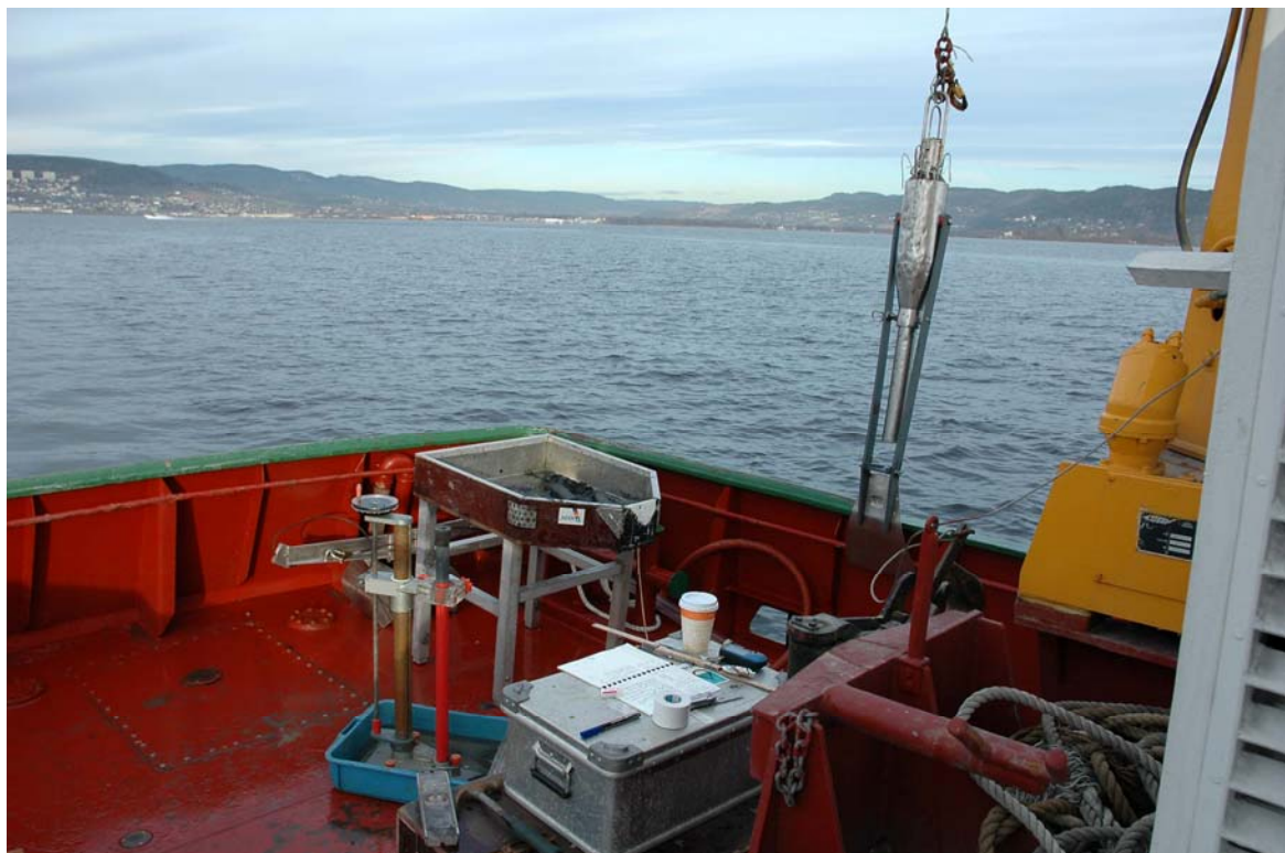
Figur 2. Situasjonsbilde fra feltarbeidet 11.11.05. Kjerneprøvetakeren henger mot rekka av båten.
