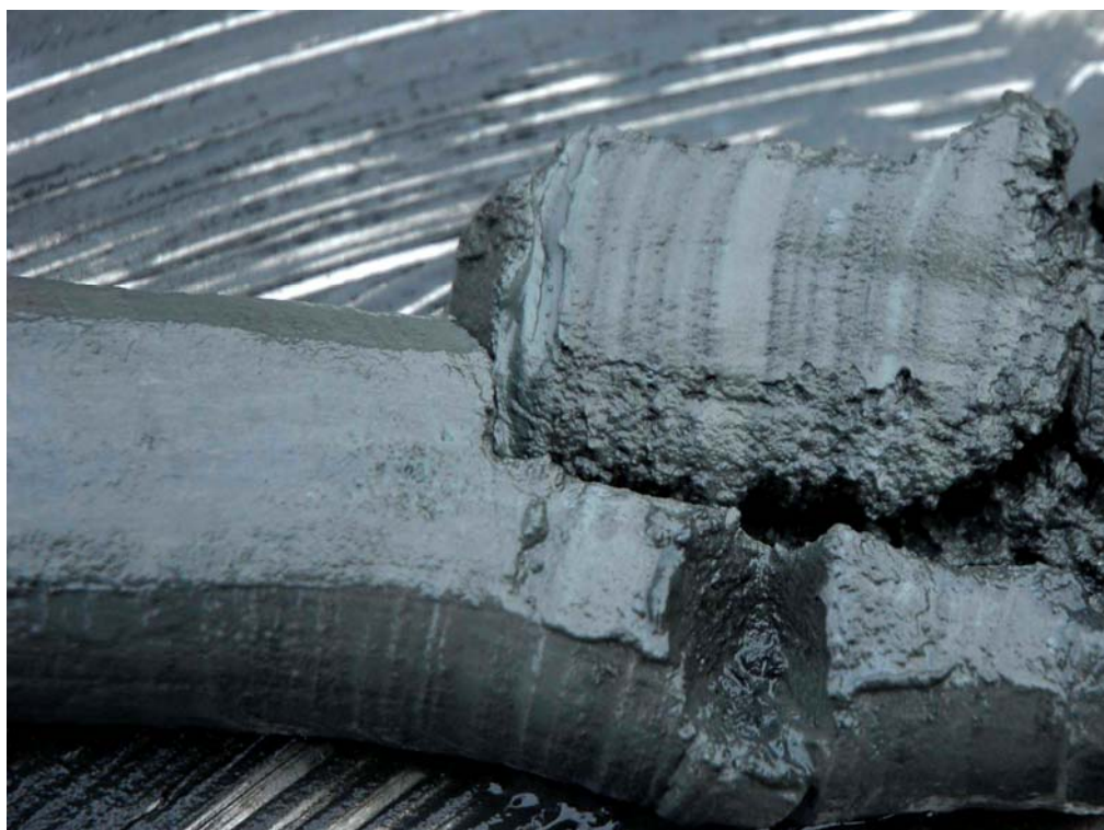
Figur 3. Sedimentkjerner fra indre del av Drammensfjorden 11.11.05. Bildene viser varvige sedimenter.
