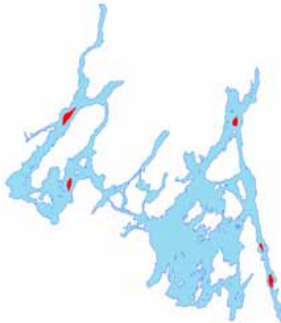
Figur 6. Horisontal utbredelse av oksygenfrie bunnområder i Vansjø, 5-6 august 2005 (skravert med rødt). Områdene representerer dyp større enn 11 m i Vanemfjorden, større enn 30 m i Rosfjorden (Storefjorden, nord) og større enn 22 m i Borgebunnen (Storefjorden, sørøst). Dypdekartet har ikke tilstrekkelig detaljeringsgrad til å vise de anaerobe områdene i Grepperødfjorden (dypere enn 6,5 m), men også her dreier det seg om meget små områder.
