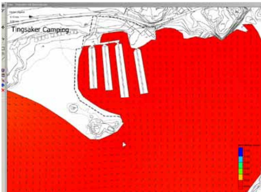
Figur 4. Scenario 2: Strømbilde for 0-1 m vannlag, med dagens utbygging og lav vannstand. Øverst: tidevann strømmer ut (før vannstandsvending). Nederst: tidevann strømmer inn.
